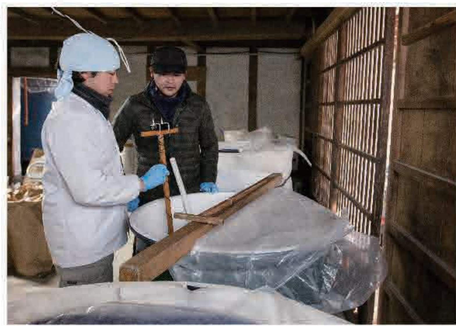
酒母の温度を測る。温度管理は繊細で一番気を使う。搾り終わった板粕は地元が待ちわびる食材だ
